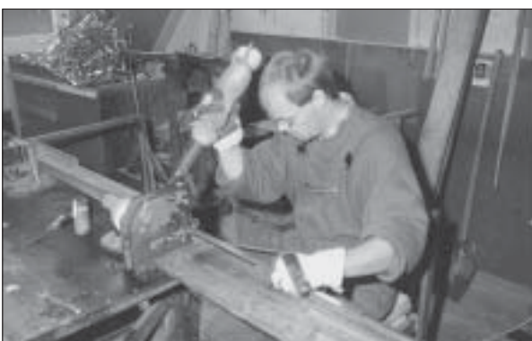
Die Löcher für die Befestigungen der verzinkten Eisenbänder stantzt der Schlosser in Handarbeit.
