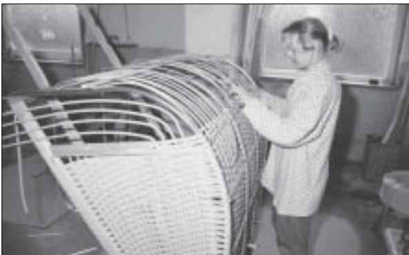
Die Beflechtung mit Plastikband ist hier Frauenarbeit. Naturrohr ist dagegen schwerer zu flechten.
